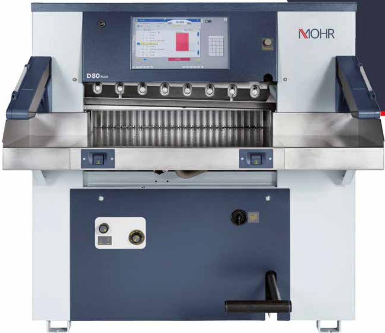
Robusta, programable, equipada con pantalla táctil de 18,5" con visualización del proceso de corte.
